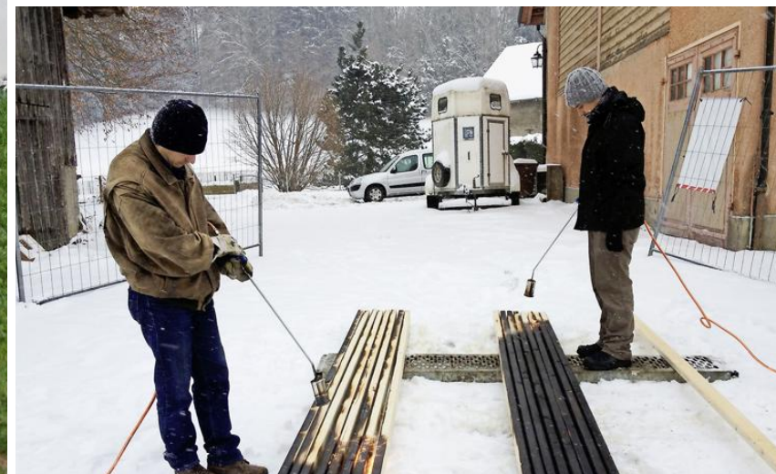
Il faut compter une dizaine de minutes pour brûler les différentes faces des bois à l'aide d'un chalumeau.
